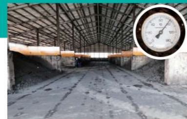
E 二次発酵槽 一次発酵した堆肥は二次発酵槽へ移送され、時間をかけて熟成させていきます。熟成が進むと温度が40度くらいに下がり、良質な堆肥が出来上がります。
