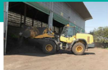
C 混合槽 微生物の発酵促進を考慮し、性状ごとに異なる廃棄物と木くず・戻し堆肥を混合し、成分や含水率を調整します。
