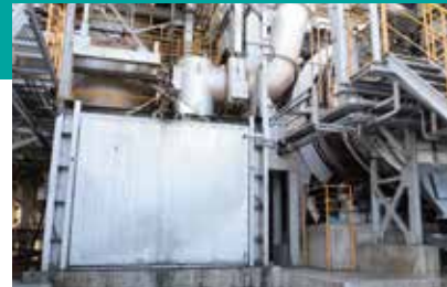
ドラム缶炉 固定炉を有しており、ドラム缶内部に固着した状態の廃棄物等を容器ごと投入して処理をすることが出来ます。処理時に発生する排ガスは、二次燃焼炉で熱処理します。
